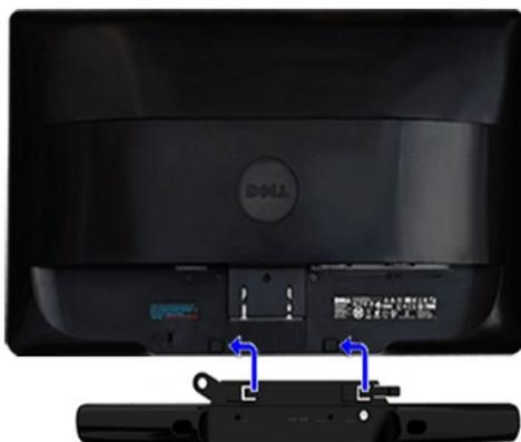
1. Desde la parte trasera del monitor, acople la Barra de Sonido alineando las dos ranuras con las dos pestañas de la parte trasera e inferior del monitor.
