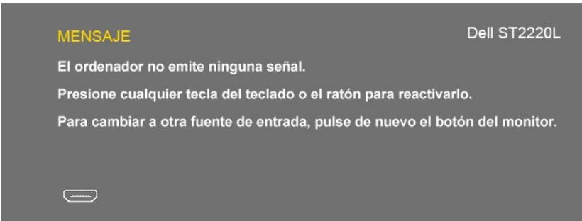
Si selecciona la entrada VGA/DVI/HDMI y no se conecta el cable VGA, DVI y HDMI, aparecerá un cuadro de diálogo flotante como el que se muestra a continuación.
